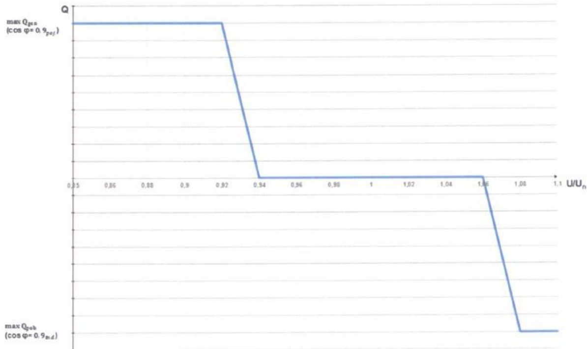
Rys.3. Charakterystyka sterowania mocą bierną w funkcji napięcia wymagana przez CMC Poland.
